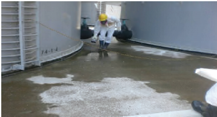
3・11以降、高濃度の汚染水を1日300トン以上、海洋流出で人類と地球を破滅に追い込んでいる福島第一原発事故。9月3日汚染水漏れのH3タンク群の底部表面で2.2シーベルトを測定。数時間で死亡する高線量をこのように測定している原発労働者。
