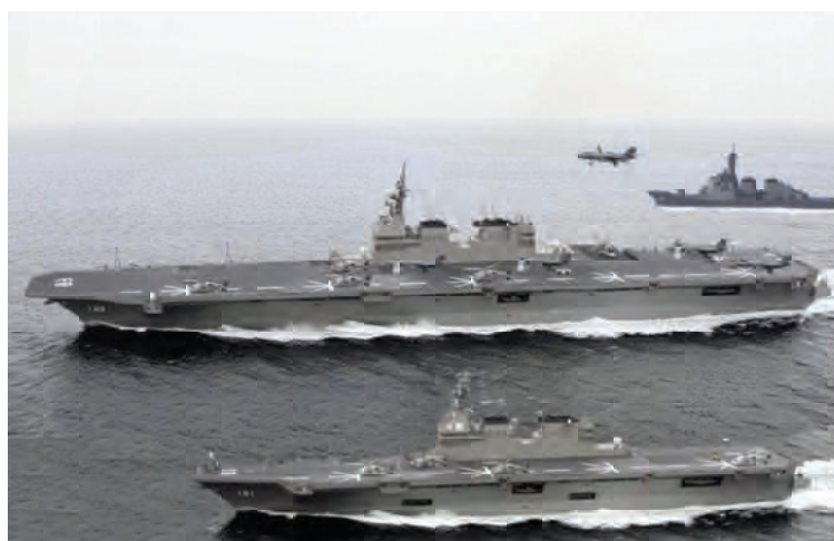
8月6日、海自最大の22DDHヘリ護衛艦「いずも」が進水。全長248m、幅約38m。手術室35人分の病床。最大500人の乗員と450人の宿泊スペース。有事に垂直離着機を搭載すれば「攻撃型空母」に転換。旧海軍空母「加賀」とほぼ同じ大きさ。上図は、「いずも」（中央）と「ひゅうが」（下）の比較を表している。「いずも」は今後、機関砲、レーダー、電子戦・対抗手段など装備し15年3頃就役。2番艦（24DDH）は12年度予算で建造費1155億円が計上、14年起工。
