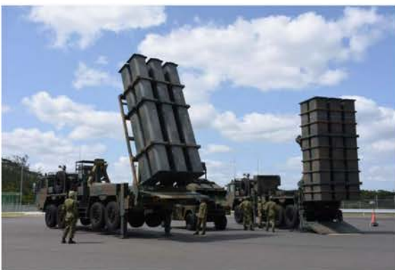
陸上自衛隊・瀬戸内分屯地に配備の12式地对艦誘導弾（左側）〈10・29南日本新聞〉
